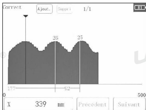
Figure 3.10 Interface de balayage de la forme d'onde pour l'ajout et la suppression manuelle des points de mesure
