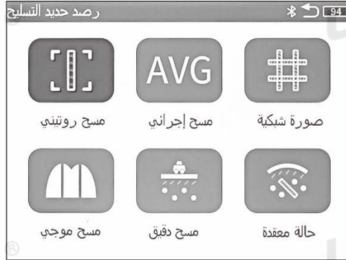
الشكل 2-3 الواجهة الرئيسية للكشف عن حديد التسليح
